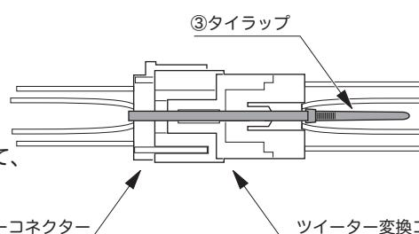
ツイーター変換コネクターと純正ツイーターコネクターの接続において、純正ツイーターコネクターのツメでロックする事が出来ません。
