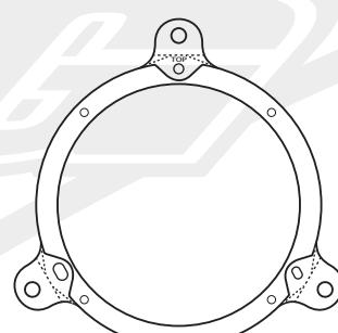
**スズキ車 1****バッフルおよびスピーカーの取り付け方****1 バッフルを車両に取り付ける**
