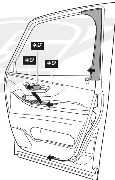
4・純正スピーカーコネクターを外し、ネジ4点を外す
