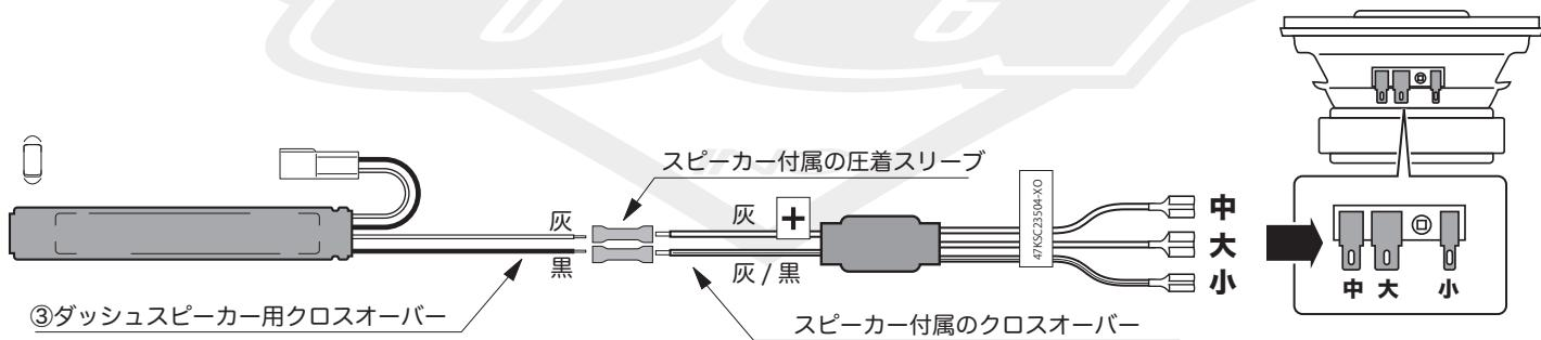
2・接続した③ダッシュスピーカー用クロスオーバーとスピーカー付属のクロスオーバーを④タイラップで縛る
