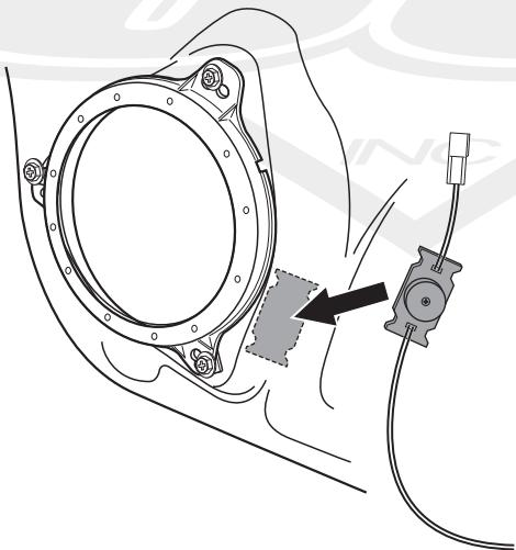
2・赤丸 2箇所のネジを緩めてドア鉄板とバッフルの間に隙間を作り、スピーカー配線をバッフルの下を通す
