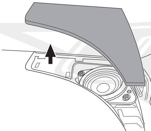
2・純正スピーカーを外し、2箇所の突起をカットする
